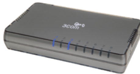
Figura 45. Switch 3com 3cgsu08a.
